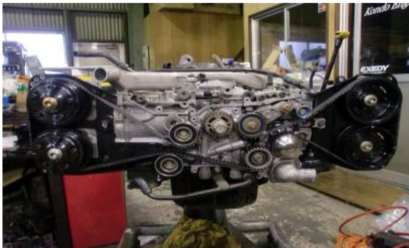
▲ スバル・インプレッサに搭載された、2リッターのボクサーエンジン。
