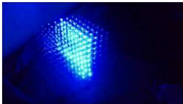
図 9 LED キューブ。Raspberry Pi を使って制御されている
